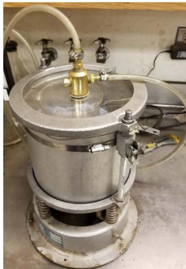
**Figure 37.  $G_{mm}$  apparatus.**
