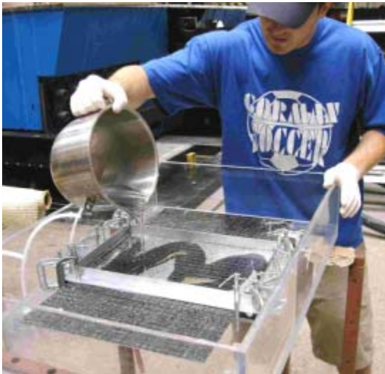
(d) Pouring Elastomer over Fabric.
