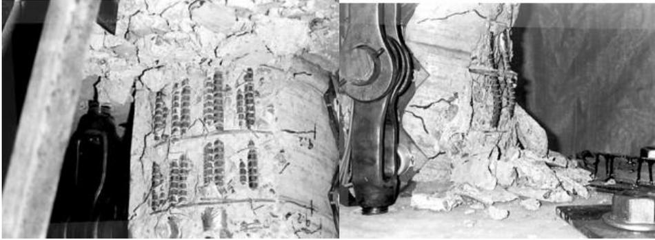
**Figure D.17** Failure of columns (Saadatmanesh et al, 1997)
